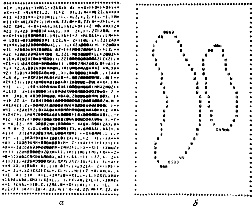
Рис. 8.10. Зашумленный образ (а) и результат определения контура, полученного с помощью метода эвристического поиска на графе [292] (б).
